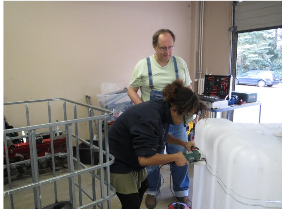
Stahlrahmen abnehmen und Behälter schneiden
