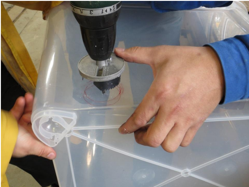
Zu- und Abflüsse bohren
