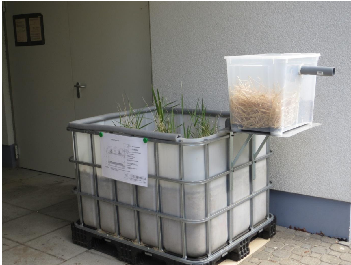
Modell mit Konstruktionszeichnung und angeschlossenen Rottebehälter (Mai 2014)
