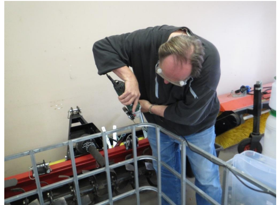
Stahlrahmen schneiden und entgraten
