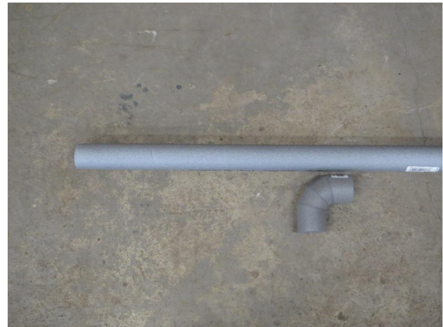
Rohrisolierung (15 mm) als Kantenschutz
