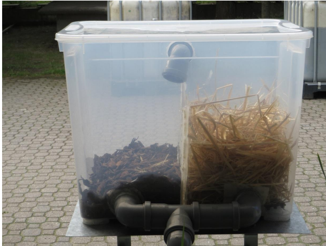
Rottebehälter mit verstellbarem Zulauf, zwei Kammern (Füllung mit Stroh und Rindenmulch) und Ablauf
